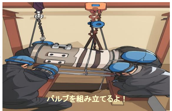
バルブ取替工事
